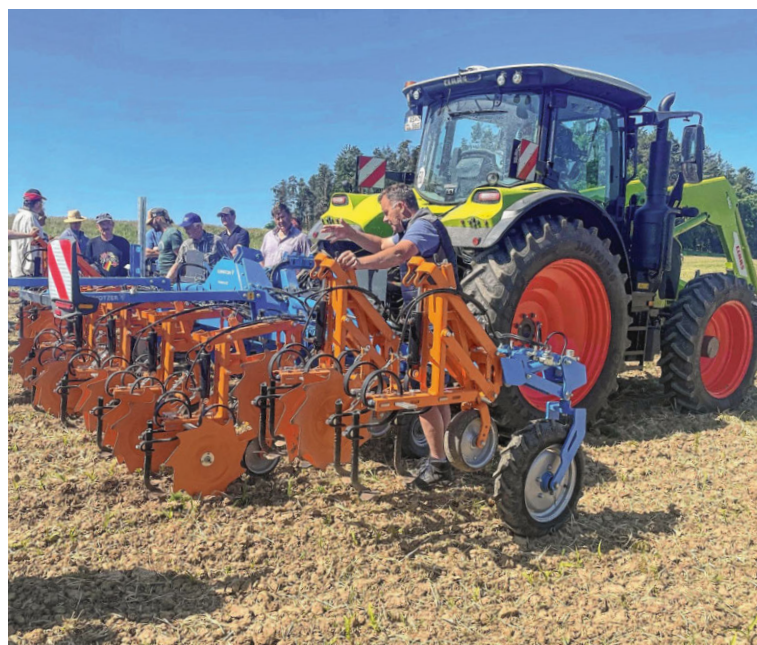
Am Praxistag zur mechanischen Unkrautregulierung in Mais werden verschiedene Techniken, wie die Kamera-Hacke, vorgeführt.
